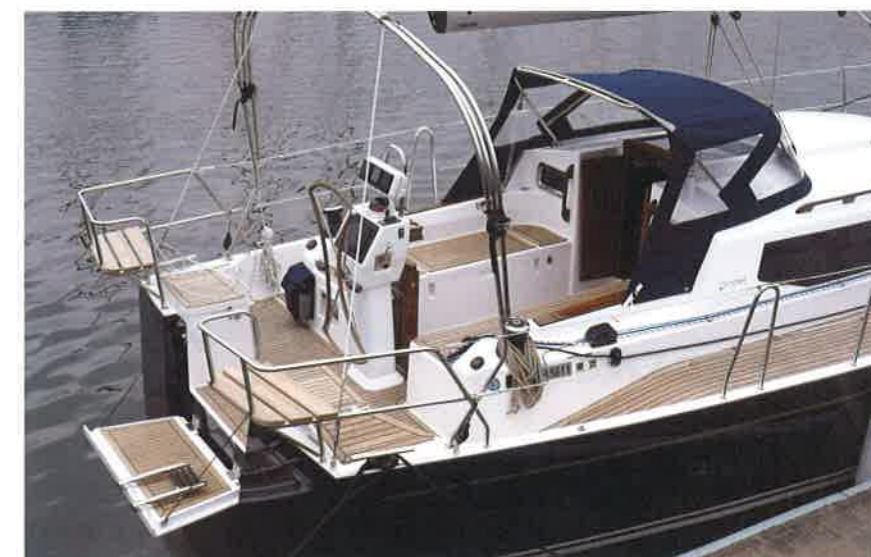
試乗艇は折りたたみ式のシングルステアリングホイール仕様。コントロールロープ類は、左右のコミングの後方にリードされている
