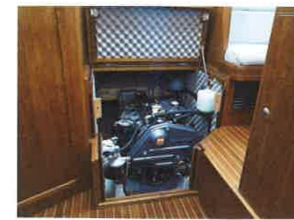
試乗艇のエンジンは、ヤンマー4JH5Eセールドライブ(54馬力)。燃料タンク容量は200リットル。機走力も高いボートだ
