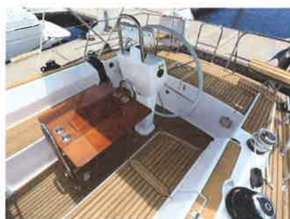
てらいのないコクピットのデザイン。奇抜なアイデアもないけれど、だからこそ落ち着けるとも言えそう。テーブルの下に少し見える足掛けは、セーリング時に体を安定させるのだと、意外な高評価を顧客からいただいているという
