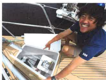
バウのチェーンロッカー。かなり深い。深く収まっているチェーンの長さは、30mもあります。ウインドラスはリモコンで操作。左舷側に見えるポールは、セルデン社製の突き出し式ジェネカーポール
