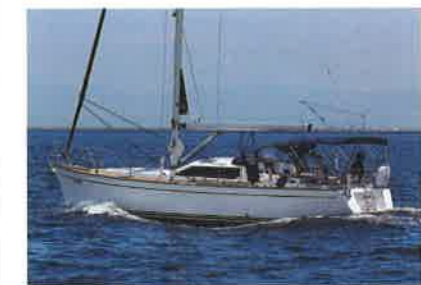
セーリング試乗を終え、機走性能を試してみた。フォールディング3翼プロペラ、3,000rpmで、ボートスピード10.1kt。抵抗の小さそうな曳き波ですね。巡航2,500rpmで、9.3kt。プロペラからの水流を、ラダーに結構感じました
