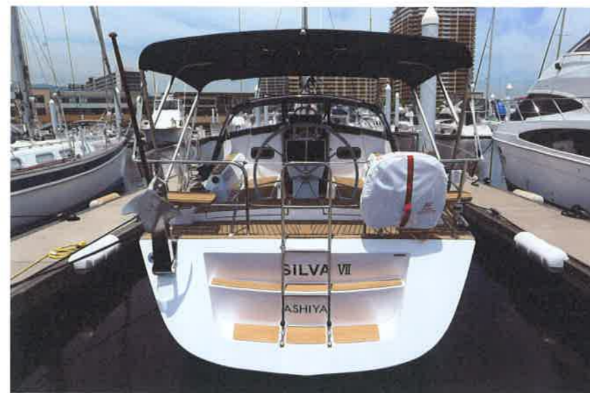
昨今はやりの欧米のプロダクション艇には見られなくなった、スリッパなデザインの船尾。カウンタースターンの岡崎386DSとは異なって、リバーシタトランサム
