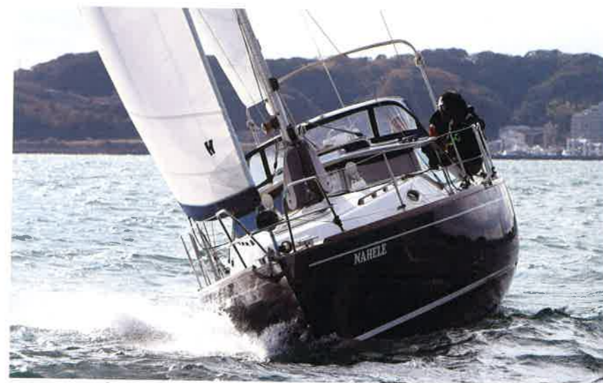
最近のボートと比べると、フリーボードは低めだ。幅も広くはなく、ハルは深い。よって、どちらかといえばビルジはスラックといえる
