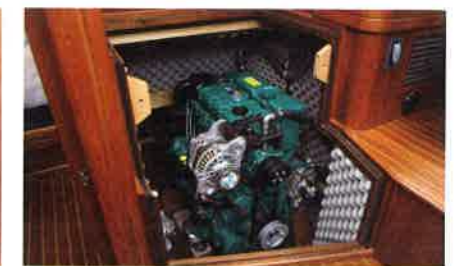
上：試乗艇のエンジンは、ボルボ・ベンタD2-50 (51馬力)。セルドライブ仕様にアップグレードされている。燃料タンク容量も、120リットルから200リットルに増やされている 左：トイレルーム。前後に長く、広さは十分だ。欧米のボートはホワイト仕上げの部分が多いが、このボートは木工も多く使われている
