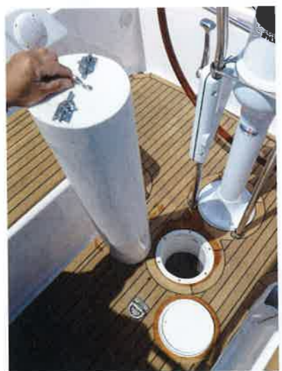
ステアリングポストの前は、プロペラと異物の絡み具合をチェックできるようになっています。室内の潜望鏡といい、このチェックホールといい、オーナーは老後のことを考えて、最小限の動きで視認できるようにしているのかもしれない
