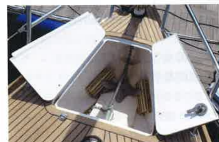
左:開口部が長さ66cm×前部幅36.5cm×後部幅63.5cm、深さが67cmのアンカーウェルの中には、33ポンドのフルスアンカーが納まります 右:パウバルピットのステップには、岡崎造船で長年営業を担当している須加田さんが加工した、同社の新ロゴマークが
