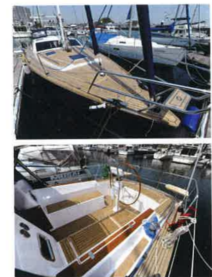
上: ステムヘッドからフォアキャビンの立ち上がりまで241cm、そこからフロントウインドウの立ち上がりまで270cmという実寸以上に、長大さを感じさせるフォアデッキ。ブルワークの高さは4cm。インナーと合わせて二つのファーラー(ファーレックス製)のスパールは、デッキに埋め込んであります。デッキ中央のスカイライトハッチはリユーマー製で、ヒンジ部分で長さ58cm×幅58cmというサイズで、マスト手前両側の方は長さ53cm×幅40cmです 下: コクピット内の床の長さは249cm、両側のシートは長さ149cm(中間で)×幅48cm×座面41.5cm。コーミングの背もたれ側は中間で高さ39cm、左右のシート間は79cmあります。ウインチはHUTTON(オーストラリア)の#52
