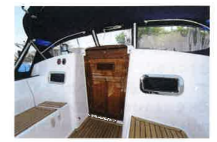
コンビアンウェイの開閉部は、下から3分の2は観音開き、その上は差し板、一番上はスライドハッチという三段がまえになっています。開口部は高さ100cm×幅61cm×奥行き63cmと、比較的大きめで行き来が楽です。ドジャーの天井高は、床から165cmあります
