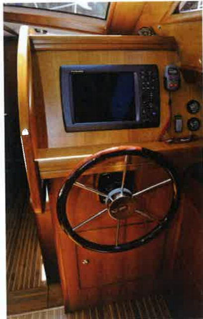
幅は最大で70cm、高さは36cmというコンソールの計器パネルに、古野電気のナビネット3Dが埋め込まれています。ピータスのステアリングは、直径は44.5cm、ポストの高さは82.5cmです
