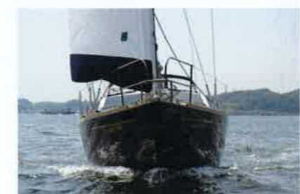
撮影レンズのせいかもしれませんが、フリーボードは高めで、ブームはさほど張っているほうではありません。船体の断面は、かなりフェアなウィングラス形ですね。ジブファラーの根元の右に見えているリングはスピンポール用で、セルデン製で内径は90.5mmです
