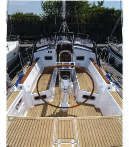
コンビアンウェイの開閉部は、下から3分の2は観音開き、その上は差し板、一番上はスライドハッチという三段がまえになっています。開口部は高さ100cm×幅61cm×奥行き63cmと、比較的大きめで行き来が楽です。ドジャーの天井高は、床から165cmあります
