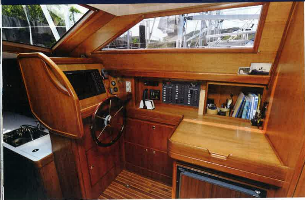
キャビン内のヘルム&ナビステーションの天井高は184cm。右側のチャートテーブルは長さ56.5cm×幅60.5cmで、高さは85cmという大きさです。テーブルの下にはENGELの冷凍冷蔵庫が備わります
