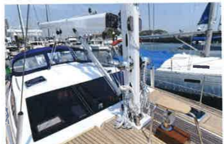
左:マスト下部周辺。セルデンのマスト&ブームに、バンクはRad Kickerという組み合わせ。傾斜角約68度のフロントウィンドウは、阪神ガラス製の強化ガラス! できています。オーナー持ち込みのベンチレーターカウルに合わせて作成されたドレードボックスが、また秀逸の仕上げでして。その上にかぶさる形のオーナーシートは、長さ31.8cm×幅21.5cmです。ブームの高さは、コクピットの床から、およそ218cmもあります 右:コクピット後部が、三つくらいアクションで下降して、ボーディングラダーになります。最下段のチークのステップの幅は63cmで、そこから43cmの高さにワンステップがあり、さらに56cmの高さにセカンドステップがあります。94kgの私が乗ってもあまり動揺しませんでした
