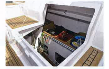
上: 開口部は長さ70cm、幅は斜めで59cmというロッカーの中は、長さ約197cm×幅約135cm×深さ約108.5cm。私サイズでも2人は楽に密航できそうな巨大空間です 下: Edsonのホイールは、直径約111cm、ポストの高さは床から73cm。元々はチークのスピンで、ピアノフィニッシュのニス仕上げは岡崎造船製です。ヘルムスマンシートを含むビーム方向のシートは、幅200cm×長さ42.5cm×座面高55.5cm。中央部を跳ね上げると、エマーゼンシー用のラダーポストが現れます
