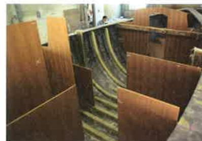
右の写真とは別の社屋では、30Cのハルに、バルクヘッドや補強材の取り付けが行われていた。この後、モールドから抜かれる。FRPの積層はハンドレイアップ方式を採用
