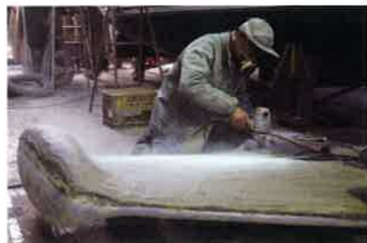
積層を終えたバラストキールに、表面を整えていく作業を行っているところ。こういった工程のそれぞれが、手作業で進んでいく
