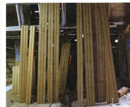
ガンネルに取り付けるチーク材。最近では、世界的に見ても良質のチークが手に入りにくくなっているのだという。チークの買い付けは、目利きが必要な難しい作業だ
