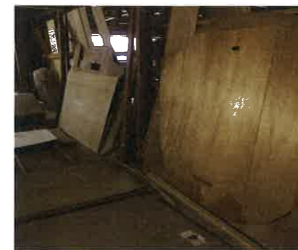
船内の部材を造るための型になる合板。1隻のヨットが完成するまでの過程のほとんどが、職人たちの手作業による。ハンドメイドの粋が結集し、ヨットが浮かぶ
