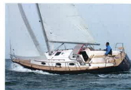
2008年にデビューした30Cは、モダンクラシックな雰囲気が漂う1艇。細身の船体に44%のバラスト比を持ち、荒天下でも安定した走りが望めるだろう
