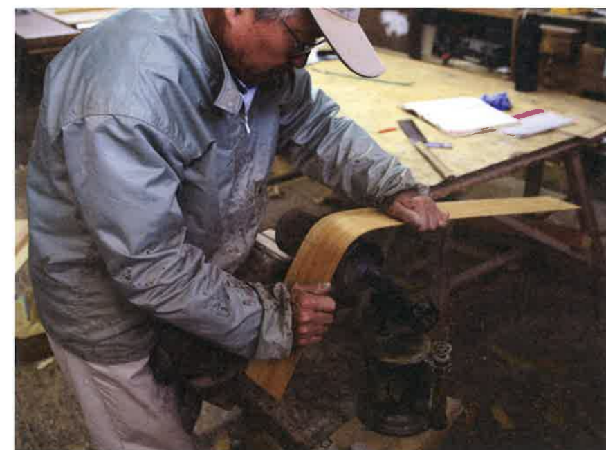
バーナーで熱した道具を使って、木材を曲げているところ。チャートテーブルの縁に使われる部材だという。カーブの角度をビタリと合わせていく作業は、まさに職人芸の域
