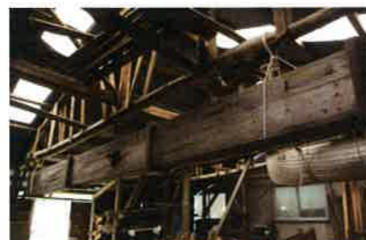
木造船が主流だった時代に使われていた蒸し曲げ用の箱。この中に蒸気を通して、木材を曲げていたそう
